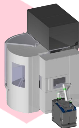
Handling System bei der Werkzeugbeladung
