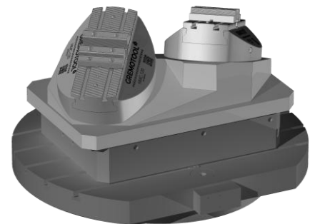
Spannmittel: 2x HMC-120 Vorrichtung: Prisma versetzt
