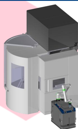
Handling System bei der Werkzeugbeladung
